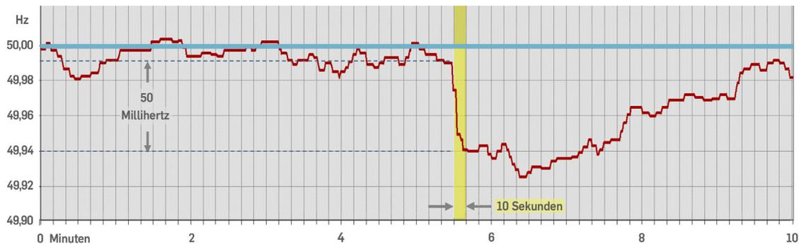
Stabilisierung der Frequenz durch Regelreserve nach Ausfall eines Kraftwerks mit 1330 MW Leistung. Um die Frequenz des Stromnetzes im Gleichgewicht zu halten, muss Regelreserve innerhalb weniger Sekunden wirksam werden.
