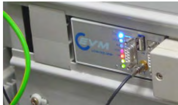
Abbildung 13: Datenkonzentrator EVM-Master, Hutschiene-Ausführung
