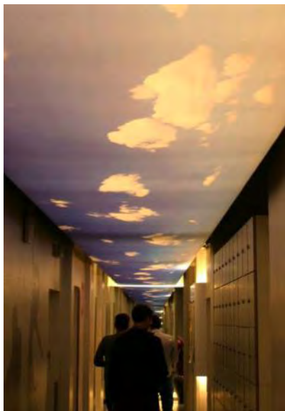
Abbildung 22: Lichtband (Himmel). Das Licht in diesem Durchgang wird per Bewegungssensor gesteuert.
