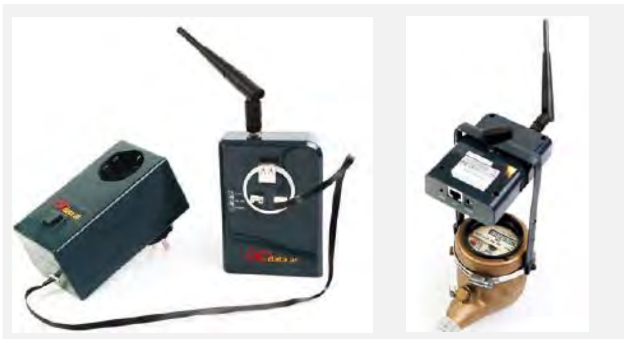
Abbildung 45: Links der GO Meter, das eine günstige Möglichkeit bietet, die Haustechnik zu automatisieren. Rechts das Go Power Modul für analoge Wasserzähler.
